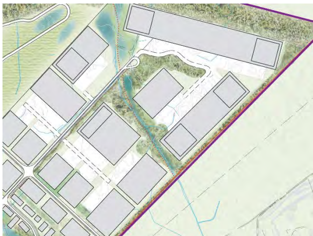
Bild 38. Detalj från strukturplanen och dess redovisning av logistikparken med schablonsatta ytanspråk i form av logistikbyggnader (grå ytor) samt omkringliggande rangerytor (vita/gråa ytor). Tyréns, 2023
