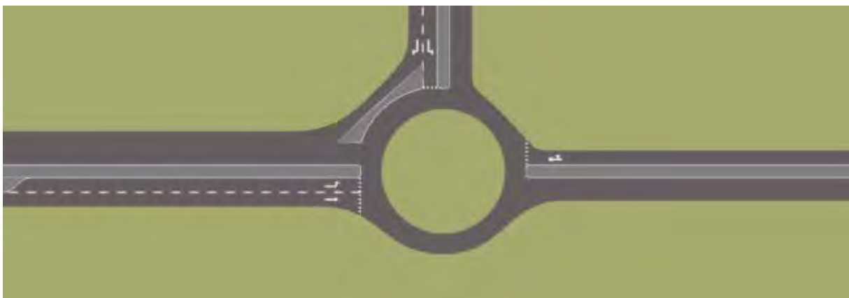
Bild 57. Kapacitetsbedömd förstärkt korsningsläge, i form av cirkulationsplats, och med utformningen/funktioner illustrerade. Tyréns, 2023
